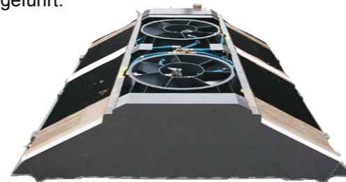
Dachkühlanlage für den AGC-Zug mit AKG Kupfer-/ Messing-Teilblockkühlern für Nieder- und Hochtemperaturkreislauf und Hochleistungsaxialventilatoren
